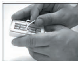
Rimuovere il biadesivo dalla parte inferiore
