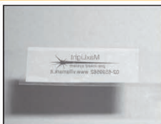
Coprire il foglio bimattato stampato con il film protettivo
