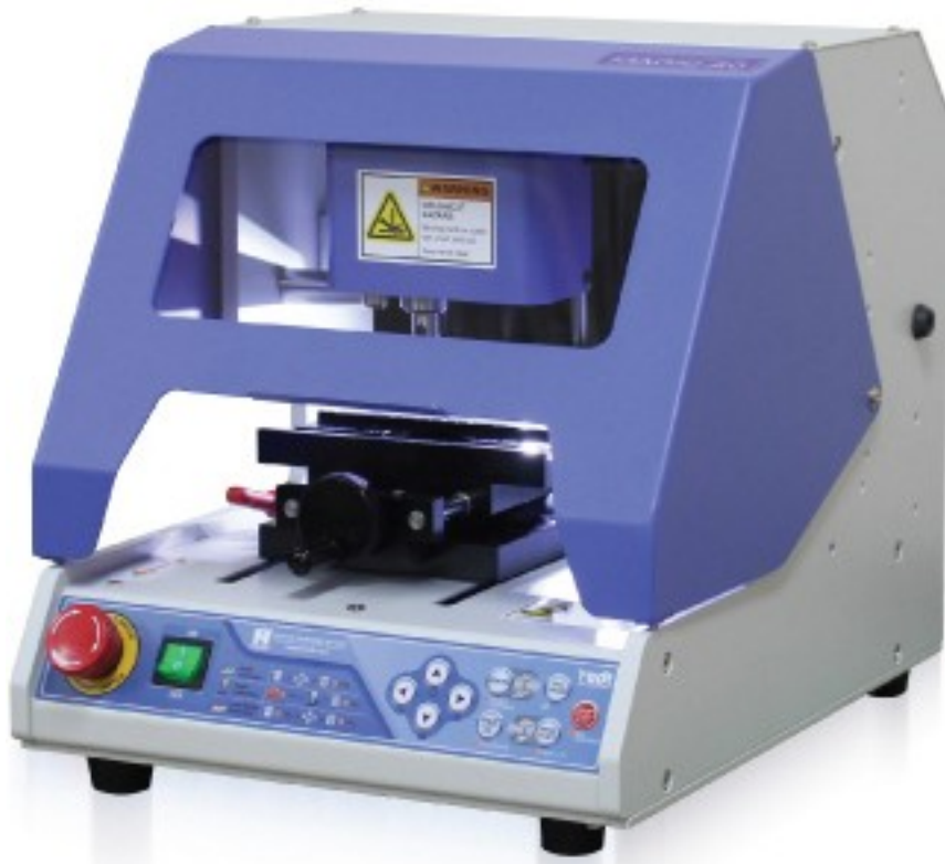
Morsa autocentrante per targhette e oggetti con superfici anche non piane
