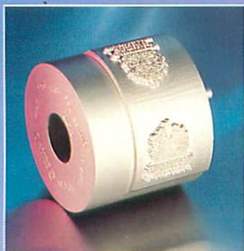
Stampo in acciaio di precisione per sigarette.
